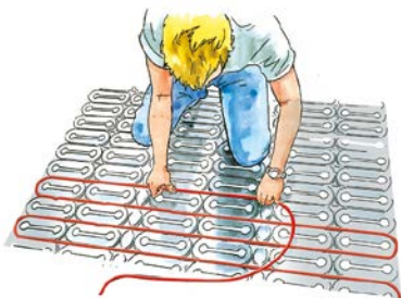
Sposób motażu kabla grzejnego z użyciem płyt DEVicell™
